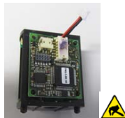
7.8 Clipser la platine électronique existante sur le nouveau support de platine
