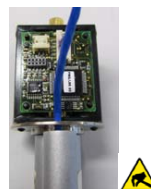
7.9 Clipser le support de circuit par dessus l'axe sur la plaque de base
