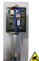
7.10 Raccorder le câble de la batterie et le câble de l'actionneur
