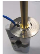
7.5 Monter la nouvelle plaque de base
