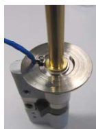
7.7 Plaque de base montée et assurée avec le clip
