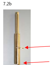
7.2b Montage de l'axe et de la bague. Axe côté extérieur du cylindre.
