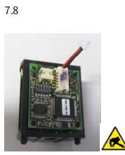
7.8 Bestehende Elektroplatine auf neuen Platinenträger aufclippen
