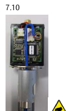
7.10 Batteriekabel und Aktuatorenkabel anschließen
