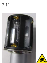
7.11 3 Stück LR 1 Batterien einsetzen
