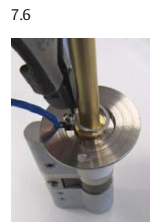
7.6 Neuer Seegerring mit KESO Spezialzange einpressen
