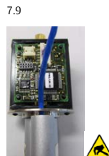
7.9 Printräger über Spindel und auf Grundplatte aufclippen
