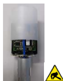
7.12 Faire glisser le cache de protection avec précaution sur le support de circuit
