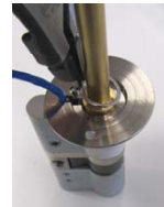
7.6 Fixer le nouveau clip avec la pince spéciale de montage KESO
