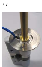
7.7 Grundplatte montiert und mit Seegerring befestigt
