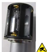
7.11 Insérer les trois piles LR 1
